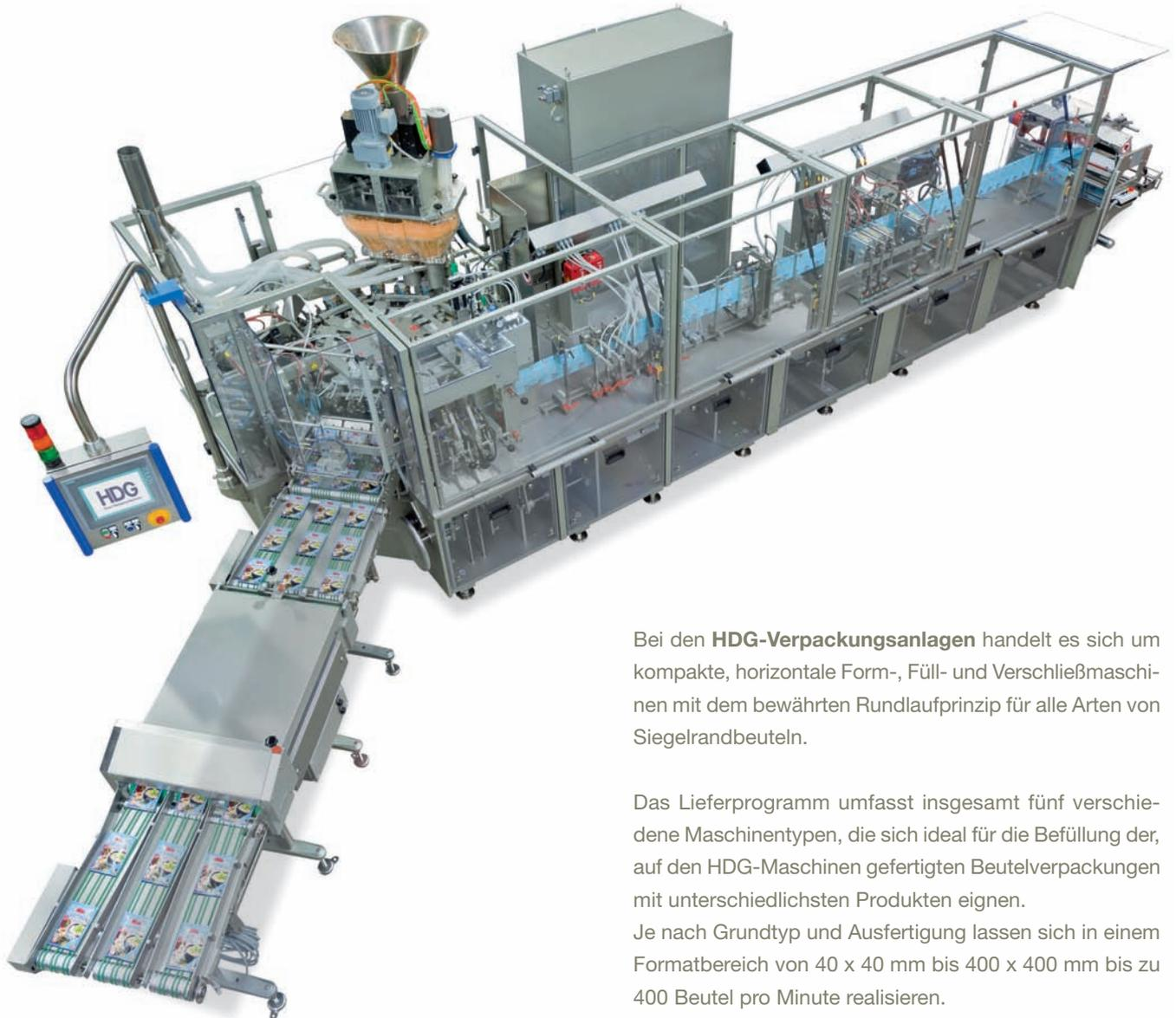
Bei den **HDG-Verpackungsanlagen** handelt es sich um kompakte, horizontale Form-, Füll- und Verschließmaschinen mit dem bewährten Rundlaufprinzip für alle Arten von Siegelrandbeuteln.
